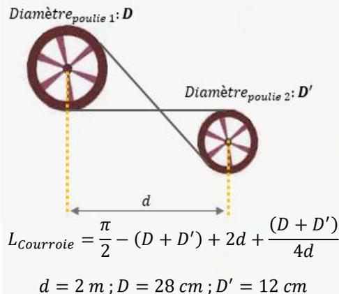
Ici, on calcule la longueur d'une courroie sur deux poulies entraînant un moteur en arrière-plan.
